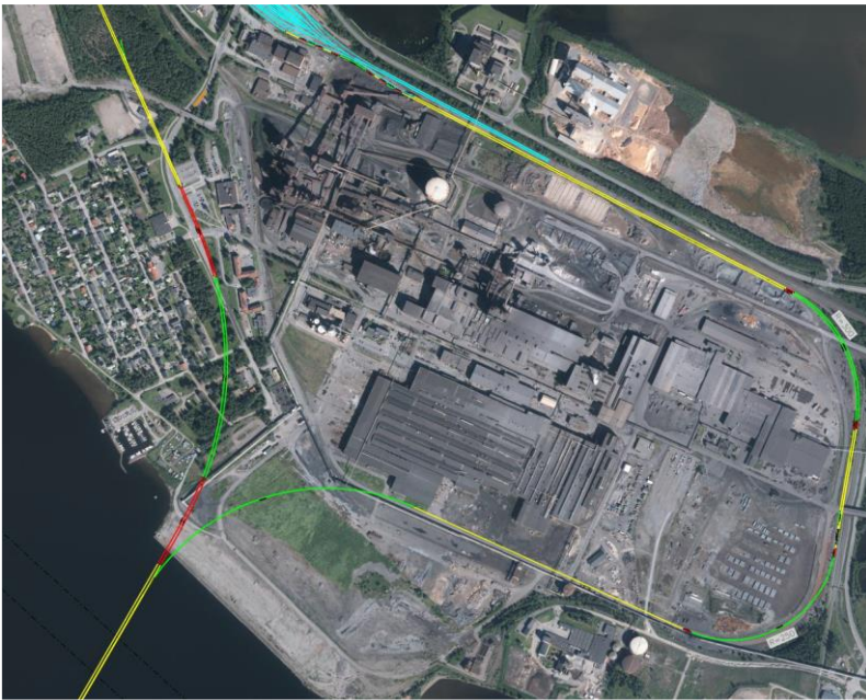
Figur 20: Förslag på spårösning UA2d – Ny järnvägsanslutning mot malmbangården (Källa: Funktionsutredning Norrbotniabanan Luleå C, godsanslutning och Luleå-Kallax, Kreera 2023-07-07).
