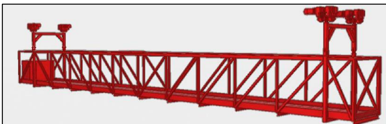
Figur 46: Exempel på utformning av servicevagn för lyftbro. (Källa: Utredning rörlig bro i Luleå med fokus på Luleås klimat, Ramböll 2022-11-08).
